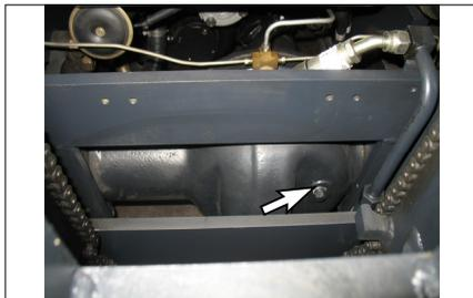
1. Поднимите экипажа достаточн высокий для того чтобы достигнуть штепсельной вилки и уровня стоказаполните штепсельную вилку.
