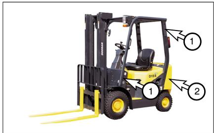
1. Проверьте закрепленность надземных болтов установки предохранителя на 105 Н•м (1) 60 Н•м (2).
