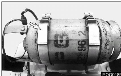
4. Откройте фиксирующие зажимы и снимите бак.
