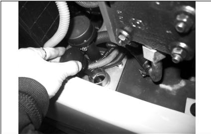
3. Извлекайте суфлера ручка dip. Масло должно находиться на уровне отметки "РШИ" крышки наполнительного отверстия или измерительного прута.
