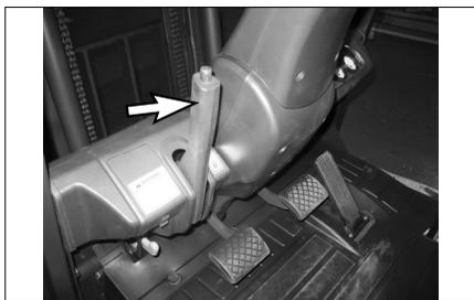
1. Поставьте машину на стояночный тормоз, если она не стояла на нем. Поставьте рычаг заднего-переднего хода в нейтральное положение.
