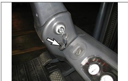
Чтобы отрегулировать положение рулевой колонки, вдавить кнопку (1) и переместить рулевую колонку в нужное положение, затем отпустить кнопку (1).
