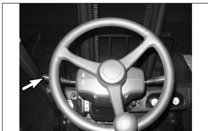
2. Поставьте рычаги коробки передач в положение “ЫЕШВАИ” (нейтральное).
