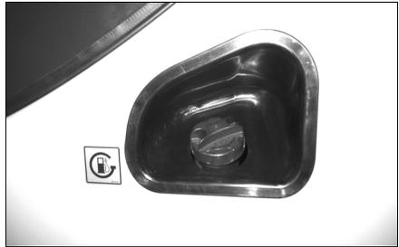
2. Снимите заглушку наполнительного отверстия.
