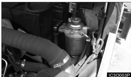
2. Снять узел фильтрующего элемента.
