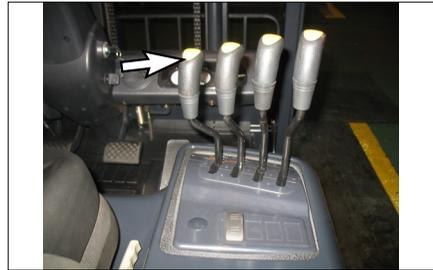
**ВНИМАНИЕ:** Избегайте резкого управления рычагами, подъемными и вспомогательными устройствами для предотвращения внезапного смещения груза.
