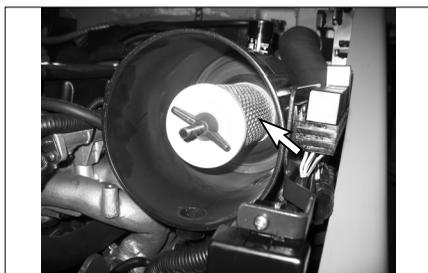
2. Выньте вторичный элемент. Проверьте состояние уплотнения между корпусом воздушного фильтра и впускным отверстием мотора. Замените уплотнение, если оно повреждено.
