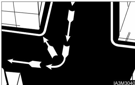
1. При поворотах на острых углах двигайтесь вдоль внутренней стороны угла поворота. Начинайте поворот, когда самое внутреннее движущееся колесо выходит на уровень угла.
