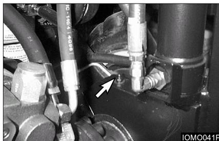
1. Опустите вилы и наклоните грузоподъемник вперед.
