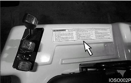
Размещено правой стороной места оператора на крышке отсека двигателя.
