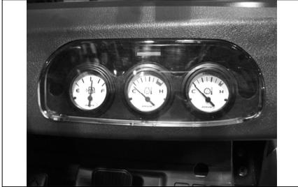
**ВНИМАНИЕ:** В соответствии с требованиями Лаборатории по технике безопасности (Организация UL) необходимо, чтобы бензобак был хотя бы на четверть наполнен при работе на сжиженном газе. Это позволит автопогрузчику снова запуститься на бензине и перейти к соответствующему месту дозаправки, при работе на опасных участках.
