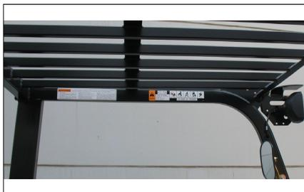
7. Проверьте, нет ли на защитной крыше повреждений и плохо закрученных или недостающих монтажных болтов.
