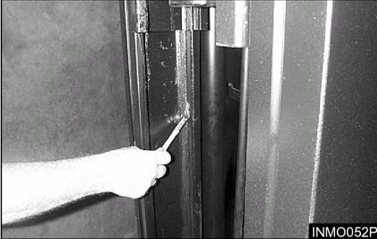
Пазы грузоподъемника роликового типа требуют периода обкатки. Нанесите тонкий слой смазки на пазы, в места, по которым двигаются ролики. Это предотвратит стачивание металла, пока ролики не обкатаются.
