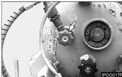
2. Закройте топливный кран газового бака. Дайте мотору работать пока он не остановится; затем выключите стартовый выключатель и поставьте выключатель блокировки (если он есть) в положение "OFF"
