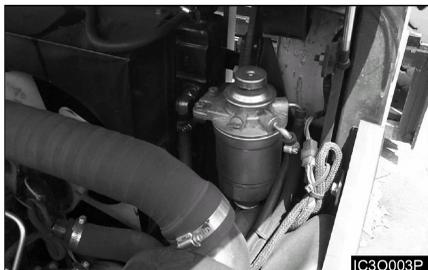
2. Отожмите топливоподкачивающий насос в верхней части корпуса топливного насоса навстречу пружине, чтобы воздух, смешанный с топливом, вышел через винт стравливания давления. Обеспечьте сбор лишнего топлива в какую-либо ёмкость или вытрите его ветошью, чтобы топливо не попало на части двигателя.
