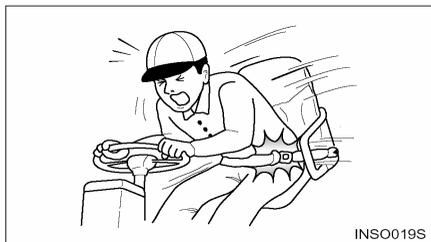
3. Если произошло опрокидывание автопогрузчика, необходимо осмотреть кресло и систему защиты водителя на предмет повреждений и при необходимости произвести их замену.
