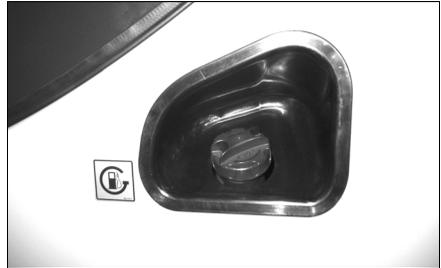
1. Снимите узел крышки заливной горловины. Промойте в чистом, невоспламеняющемся растворителе.
