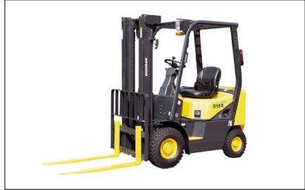
1. Паркуйте автопогрузчик только в специально предназначенных для этого местах. Поставьте коробку передач в нейтральное положение. Опустите вилочный захват на землю, оставьте машину на стояночный тормоз. Остановите мотор.
