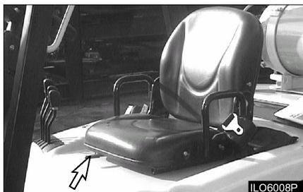
1. Проверьте исправность работы регулятора положения сидения водителя. Проверьте, плавно ли перемещается сидение по рельсам. При необходимости слегка смажьте рельсы регулирующего устройства
