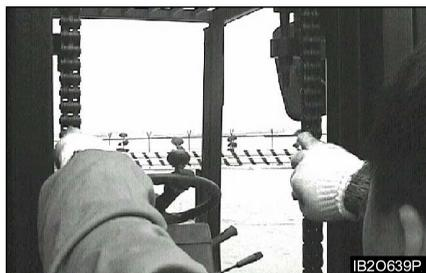
Пример одинакового натяжения цепей на грузоподъемной раме
