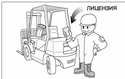
На вилочных автопогрузчиках может работать только персонал, прошедший надлежащее обучение и имеющий соответствующее разрешение. При работе на автопогрузчике надевайте каску и защитную обувь. Нельзя носить свободную одежду.
