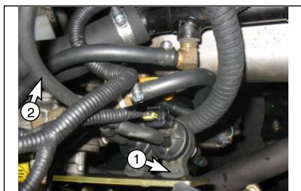
(1) Клапан регулировки подачи топлива (FTV)
