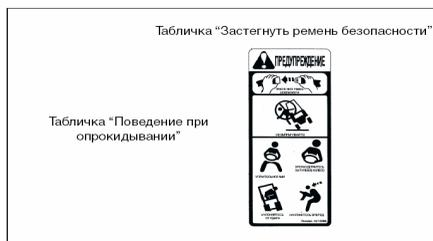
Предупредительный знак "Поведение при опрокидывании" находится на верхней защитной штанге кабины. Здесь показаны правила пользования системой защиты водителя.
