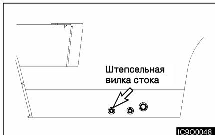
1. Выньте заглушку сливного отверстия гидравлического резервуара. Позвольте маслу слиться. Почистите заглушку и вставьте ее обратно.
