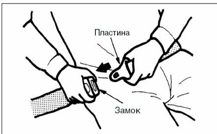
1. Возьмитесь за пластину (соединительную) на ремне безопасности и вытяните ремень из натяжителя. Затем вставьте пластину в отверстие на замке, пока не услышите щелчок. Потяните за ремень, чтобы убедиться, что ремень крепко держит.
