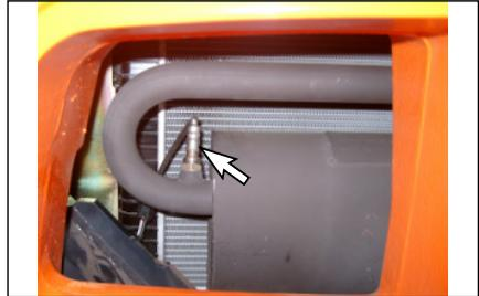
Когда указано лампой MIL, замените датчик кислорода на выхлопном манифольде и датчике кислорода на агрегате глушителя.
