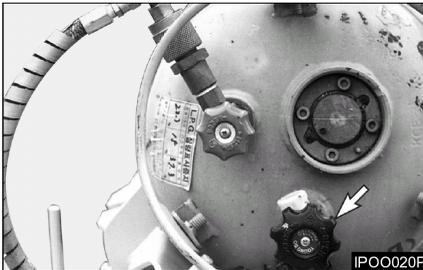
9. Проверьте, не загрязнен ли предохранительный клапан, а также исправность других клапанов и индикаторов уровня жидкости.
