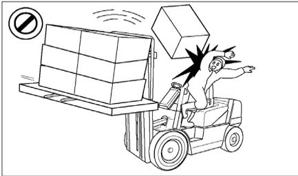
Нельзя работать на автопогрузчике без выдвижной опорной каретки и защитной крыши. Груз должен прилегать к опорной каретке, а грузоподъемник отклонен назад.
