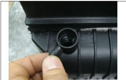
4. После слива хладагента полностью, закройте сливной клапан радиатора и сливной штепсель блока, заполните двигатель и радиатор полным с уборщиком радиатора, и очистите двигатель и радиатор.
