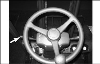
4. Выберите желаемое направление, отклоняя рычаг вперед, чтобы двигаться вперед или назад для того, чтобы двигаться назад.
