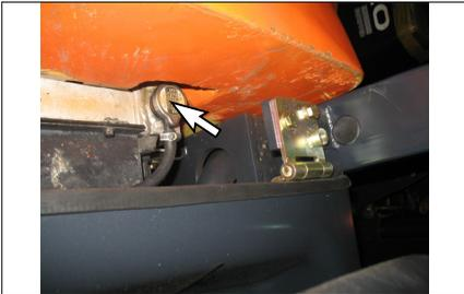
3. Заведите мотор и дайте ему поработать пока уровень охладителя у наполнительного отверстия не стабилизируется. При низком уровне доливать СОЖ, пока она не дойдет до верха заливной горловины. Поставьте заглушку обратно. Проверьте уровень охладителя в бутылке восстановления. Долейте охладителя в систему до уровня отметки на бутылке восстановления. При необходимости долить СОЖ до соответствующей отметки на складной бутылки.
