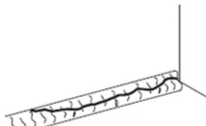
Трещина на сварном шве
