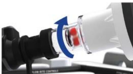
Рис. 19: Следите за индикатором потока
