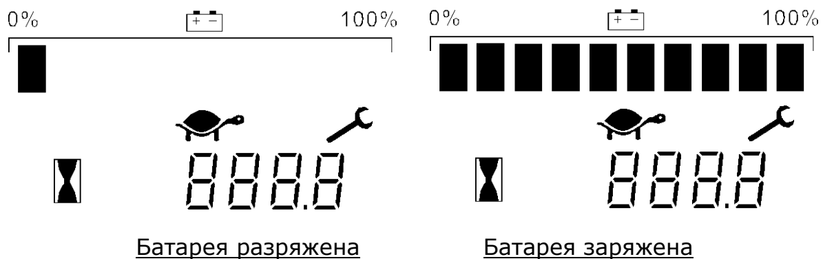
Рис.13: Индикатор заряда АКБ
