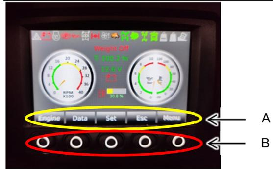
На эту панель выводится основная информация, требующаяся для контроля работы машины. Доступные страницы и параметры отображаются в нижней части экрана [A] и управляются соответствующими кнопками, расположенными ниже [B].
