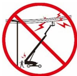
В случае соприкосновения машины с линиями электропередач, находящимися под напряжением, необходимо удалиться от машины. Находящиеся на земле или на платформе работники не должны касаться
