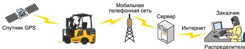
\* Система КОМТРАХ использует мобильную телефонную сеть. Она может использоваться в местах, не доступных для электрических сигналов связи, или там, где их прием неустойчив.
