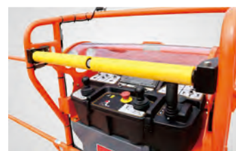
Система защиты от заземления
