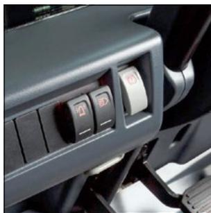
Электрический стояночный тормоз, управление простым нажатием кнопки
