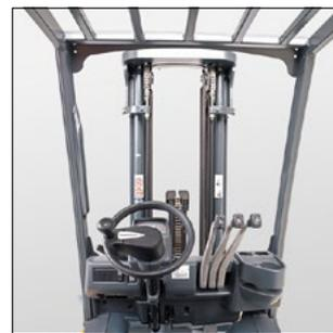
Улучшенный обзор груза, благодаря оптимизации конструкции мачты.
