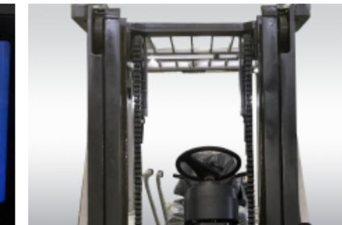
Стандартная мачта обладает хорошей обзорностью, высокой эффективностью работы, защитный демфер для плавного опускания предотвращает опасность возникновения ударов при опускании мачты. Мачта из швеллерного профиля большого сечения характеризуется высокой прочностью конструкции и отличной несущей способностью.
