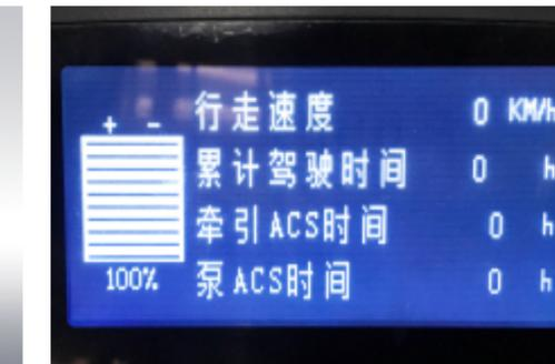
ЖК-дисплей с интерактивной системой управления, с широким спектром настроек режимов движения погрузчика, грузоподъемных характеристик, с системой контроля рабочего состояния электродвигателя, с счетчиком моточасов.
