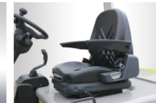
(Дополнительное оборудование): сиденье оснащено системой присутствия оператора, в случае отсутствия оператора на сиденье, оборудование будет заблокировано.
