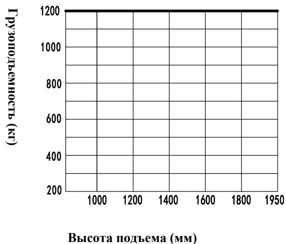
График падения остаточной грузоподъемности
